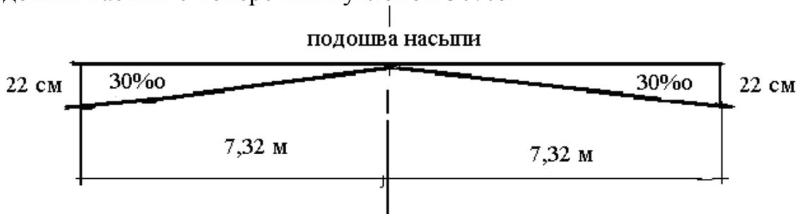
Рис. 5. Схема срезки грунта подошвы земляного полотна
