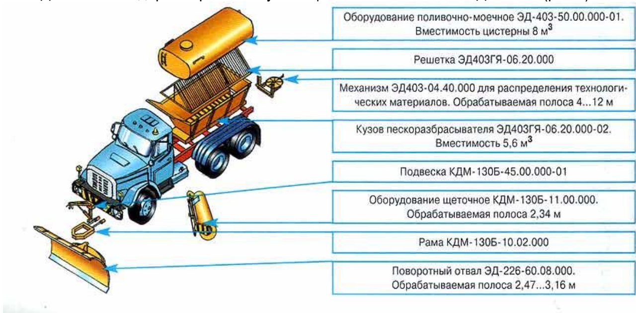
Рис.9. Плужно-щёточный очиститель КДМ-130Б
