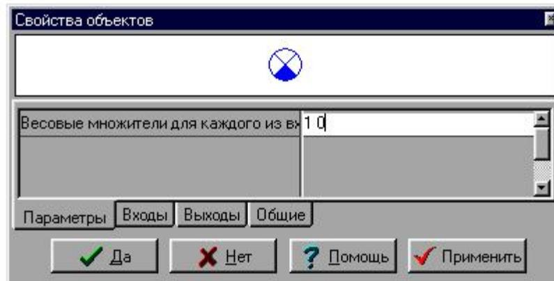
Рис. 3.1.3. Для размыкания контура первый весовой множитель сумматора оставлен равным 1, а второй задан равным нулю.
