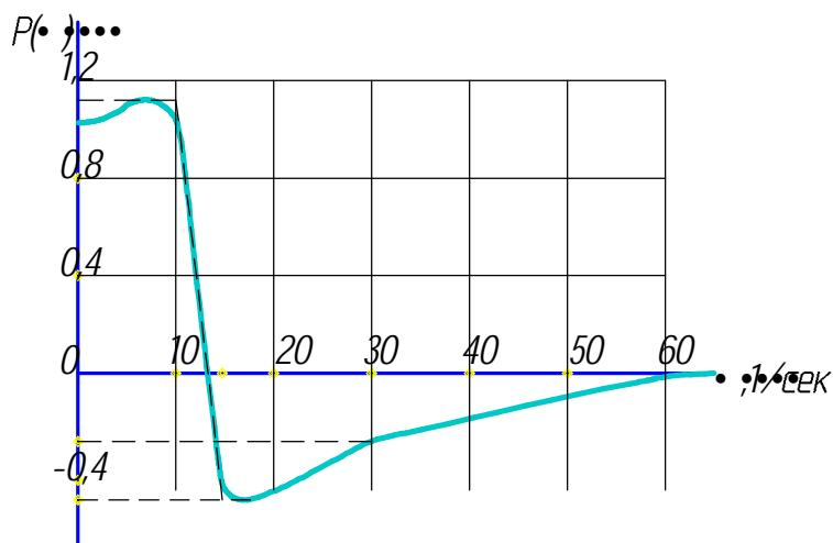
Рис.3.3.1 Вещественная характеристика  $P=P(\omega)$  и разбиение её на участки с одинаковыми наклонами
