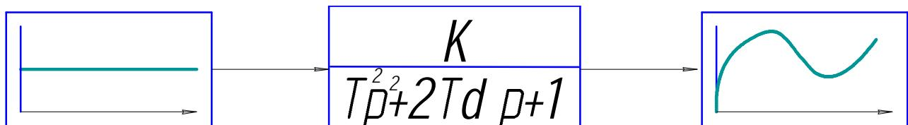
Рис. 2.3.1 Структурная схема для исследования колебательного звена
