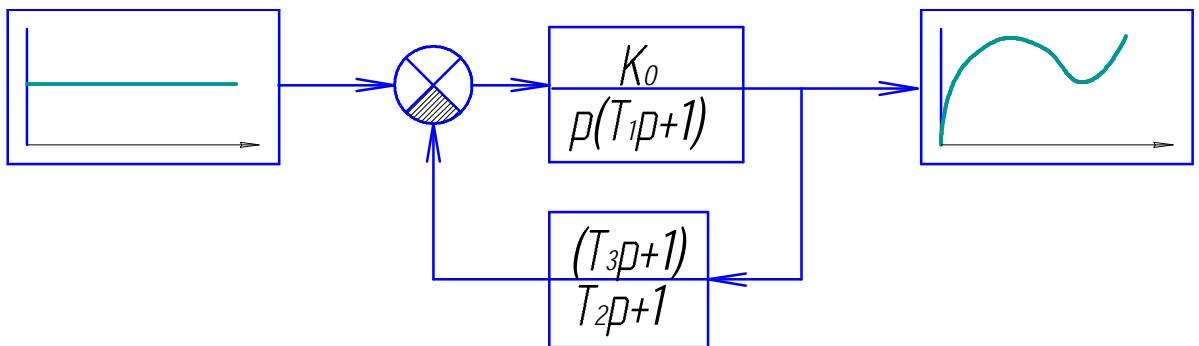
Рис. 3.1.1 Структурная схема САР
