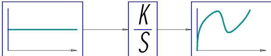
Рис. 2.2.1 Структурная схема для расчета и исследования переходных процессов интегрирующего звена
