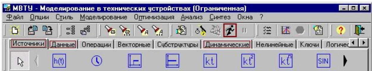
Рис. 1.1. Главное окно ПК "МВТУ". (Выделены кнопка Пуск (Продолжить расчет) и три важных вкладки Меню с наборами элементов (виртуальных блоков), которые будут использоваться при моделировании: *Источники сигналов* (генераторы) – вкладка открыта, *Данные* (индикаторы и регистраторы) и *Динамические звенья* (элементы линейных систем и систем в целом).
