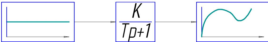
Рис. 2.1.1 Структурная схема модели для исследования апериодического звена
