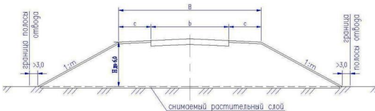
Рис. 2 . Насыпь высотой до 6 м
