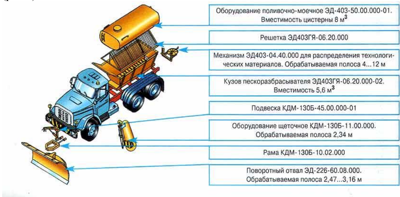
Рис.9. Плужно-щёточный очиститель КДМ-130Б
