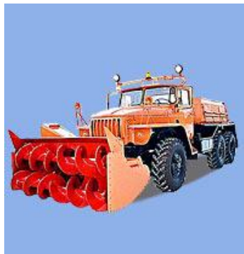
Рис. 11. Снегоочиститель шнекороторный КО-605
