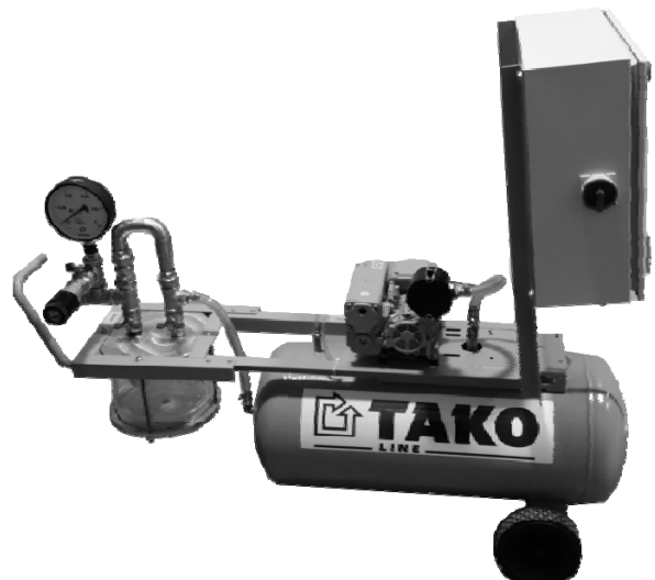
Рис. 3.3. Мобильная вакуумная станция для вакуумной инфузии TLS100-20
