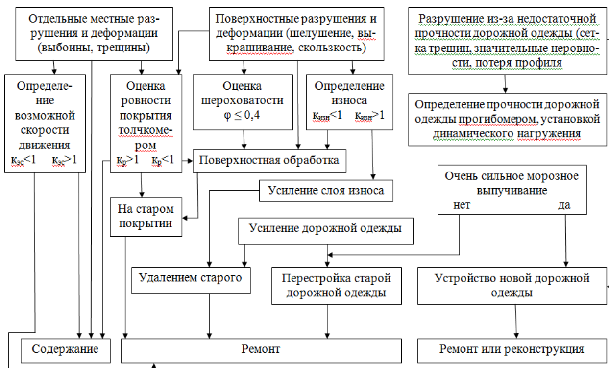
Рис.1. Планирование дорожно-ремонтных работ
