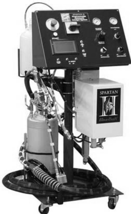
Рис. 3.1. Оборудование для напыления гелькоута Graco: а) установка для нанесения гелькоута с внутренним смешением 16R002; б) установка для нанесения стеклопластика внутреннего смешения 16R004
