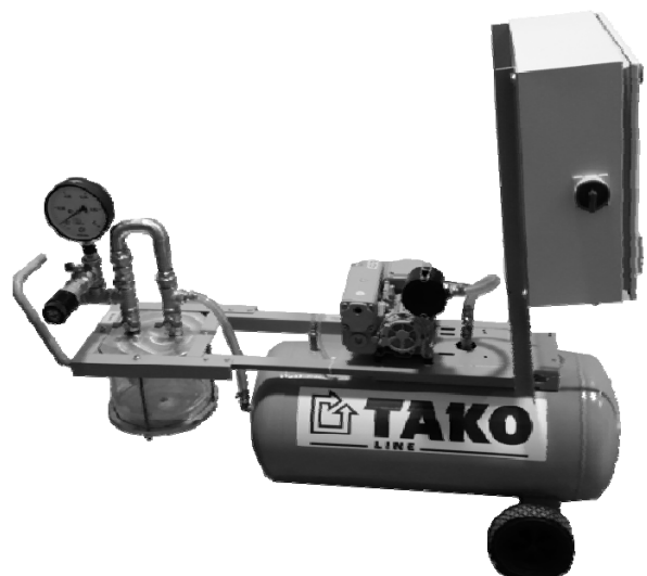
Рис. 3.3. Мобильная вакуумная станция для вакуумной инфузии TLS100-20
