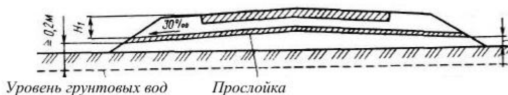
Рис.2.10.7. Конструкция влагоизолирующей прослойки
