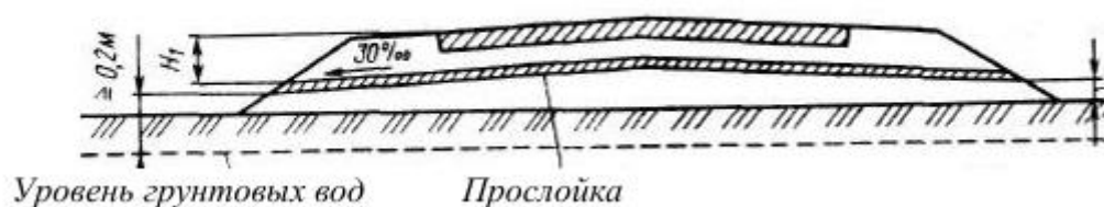
Рис.2.10.7. Конструкция влагоизолирующей прослойки
